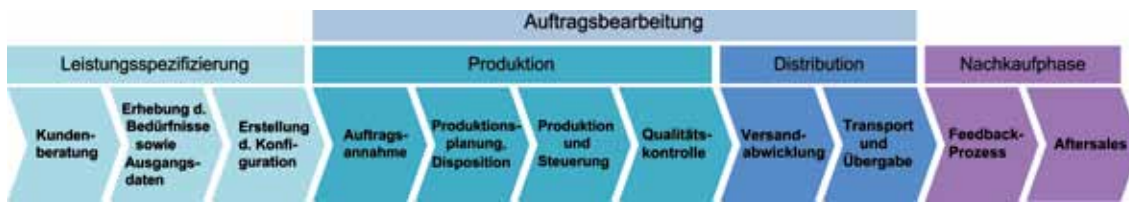
Abbildung 1: 11 Module des Referenzprozesses für Mass Customization
