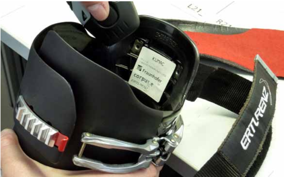
Abbildung 3: Verheiratur von Skischuh und RFID-Tag
